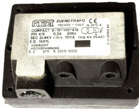
Transformateur professionnel 2x4000V, 10mA, primaire 415V, 50Hz sans câble d'alimentation Type Portotecnica. Raccordement câbles h.t. via con connecteurs Ø4,00
