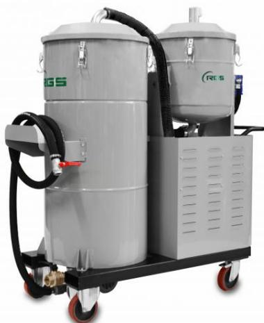
Le A 204 OIL-P est un aspirateur industriel triphasé adapté au travail en continu et intensif, idéal pour l'aspiration des huiles et boues. Dôté d'une turbine triphasée à canal latéral avec carter de protection, cet appareil est particulièrement compact avec une capacité de cuve pour liquides de 200 litres. Cette version permet de refouler les liquides simultanément pendant l'aspiration.
